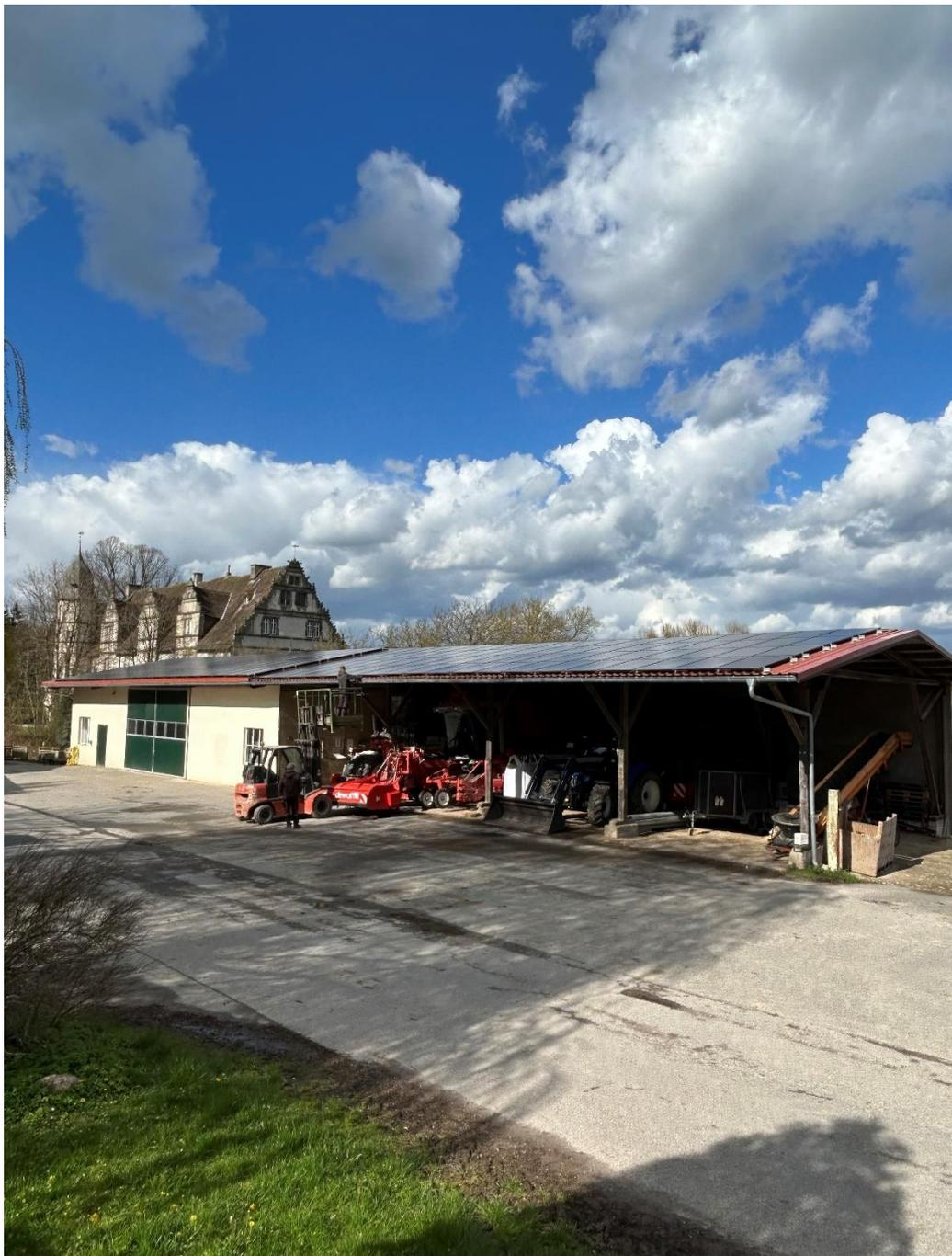
Auf der, unter Ensembleschutz stehenden, Werkstatthalle wurde 2022 das Eternitdach beseitigt und 100 kW PV mit Speicher und einer Senec Cloud errichtet
